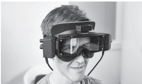
Hình 1. Cấu tạo kính VNG của hãng Interacoustic, Đan Mạch
